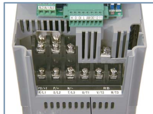
Zaciski do podłączenia zasilania oraz silnika
